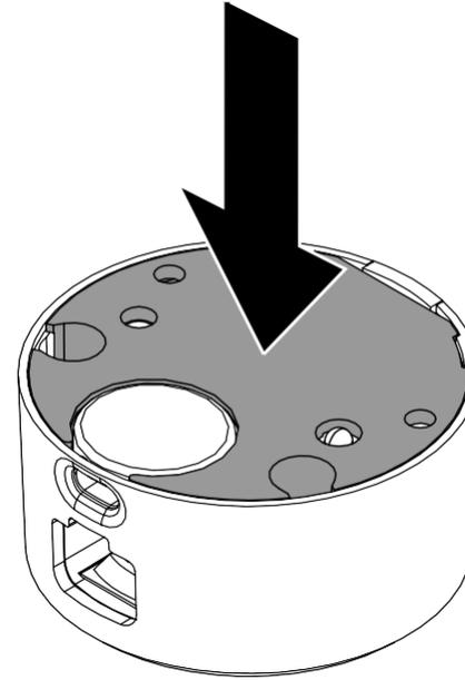
6f Masukkan dan kencangkan baut untuk menahan pelat dasar ke Unit Alarm.
