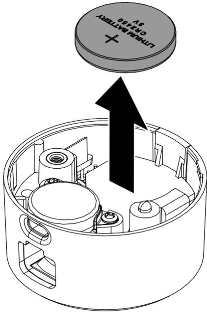
6d Masukkan baterai CR2450 baru, dengan Sisi Positif (+) menghadap ke atas, ke dalam tempat baterai.
