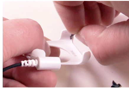
9b ลอกกาวเดิมทั้งหมดออกจากรูทุกด้านของเซ็นเซอร์
