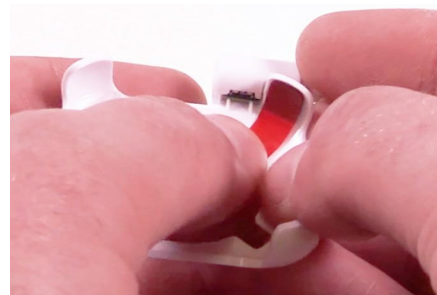
13 ติดแผ่นกาวอย่างระมัดระวัง ให้แผ่นใสชี้ไปด้านกลางของเซ็นเซอร์
