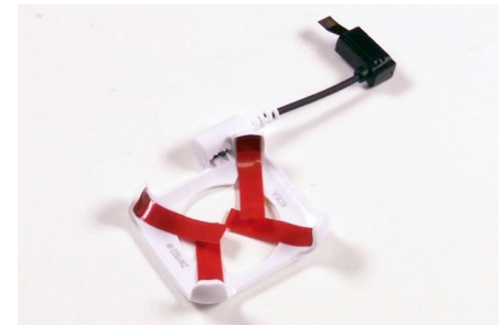
15 ติดกาวอีก 3 มุมที่เหลือ ขณะนี้เซ็นเซอร์ พร้อมสำหรับทดแทนเรียบร้อยแล้ว
