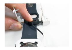
Colokkan sensor pada flex tray sensor ke ujung kabel sensor, seperti yang ditunjukkan pada foto.
