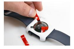
Balik perangkat jam dan cabut 4 plastik penarik adhesive(3M) merah melalui lubang di bagian bawah sensor tray.
