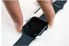
Tekan 4 sisi ujung pojok tray sensor dan tahan selama 10 detik, agar menempel dengan baik ke perangkat jam.
