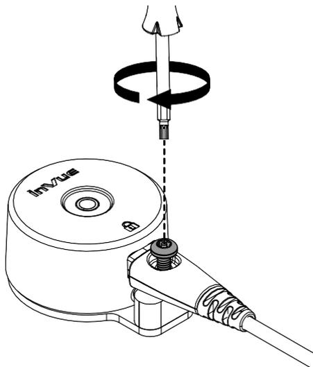
**9** Untuk mencopot sensor dari unit alarm; pakai kunci yang diisi dan diberi kode untuk menonaktifkan unit, lalu taruh kunci magnet ke ikon kunci pada unit alarm di atas sensor. Dorong sedikit dan cabut sensor.
