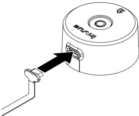
**6b** Sambungkan kabel daya ke catu daya (PS512). Colokkan catu daya ke stopkontak.
